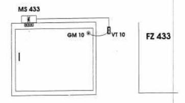
Der Glasbruchmeider GM 10 wird direkt auf die zu schützende Scheibe geklebt. Beim Zerstören der Scheibe wird der in Plastik eingegossene Sensor unterbrochen und löst Alarm aus.
